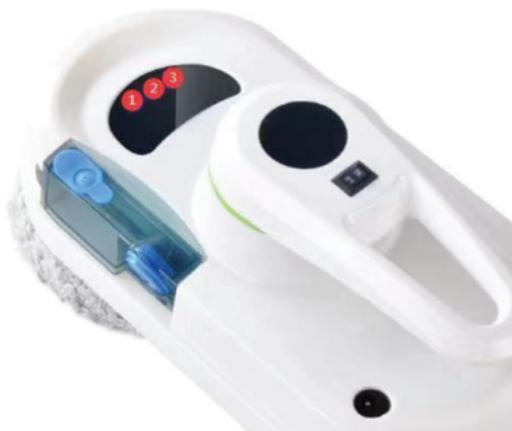
**El primer LED de la izquierda (1)**, indica el estado de la batería. Cuando el nivel de la batería es bajo o la batería se está cargando, el indicador se ilumina en rojo. Cuando el robot está cargado, el indicador se vuelve azul.
